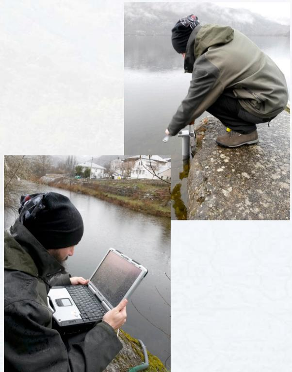
*Control y volcado de datos del sensor de nivel del lago y del tomamuestras y sensores en el río Tera a su paso por Ribadelago Viejo.*
