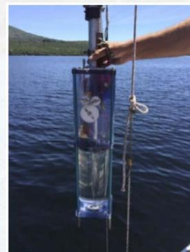
Muestreador integrado, que integra un número determinado de metros de profundidad de la columna de agua en una única muestra.
