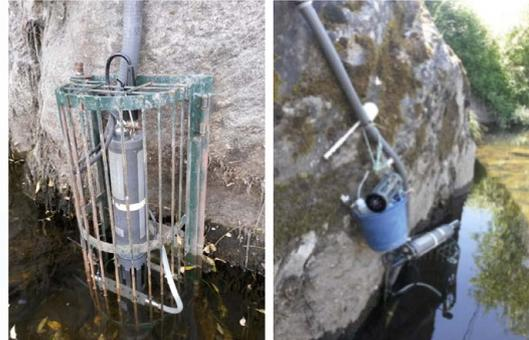
Sonda multiparamétrica en el río Tera, con el nivel mínimo de agua en el estiaje a finales del verano.
