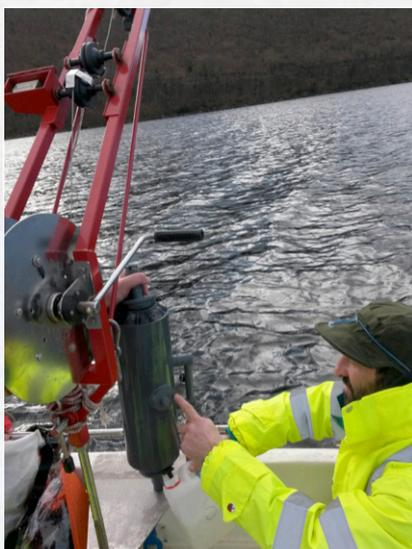
Obtención de una muestra de agua del fondo del lago utilizando una botella hidrográfica con torno.
