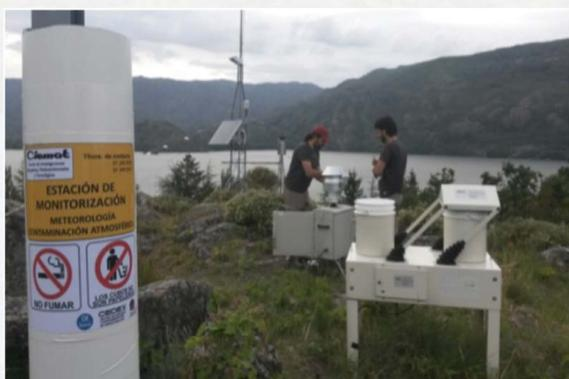
Tareas de mantenimiento de la estación de monitorización meteorológica y de contaminación atmosférica en las orillas del lago.
