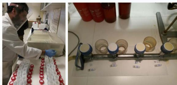
*Procesamiento de las muestras de agua en el laboratorio del Parque Natural y filtros de agua para análisis de pigmentos, en los que se puede apreciar la diferencia de color entre los puntos de muestreo.*
